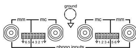
Les entrées phono sont symétriques. Le réglage du commutateur de mise à la terre en position élevée permet au signal d'entrée d'être référencé à la terre, ce qui est parfois utile en cas de bruit excessif ou de bourdonnement.
