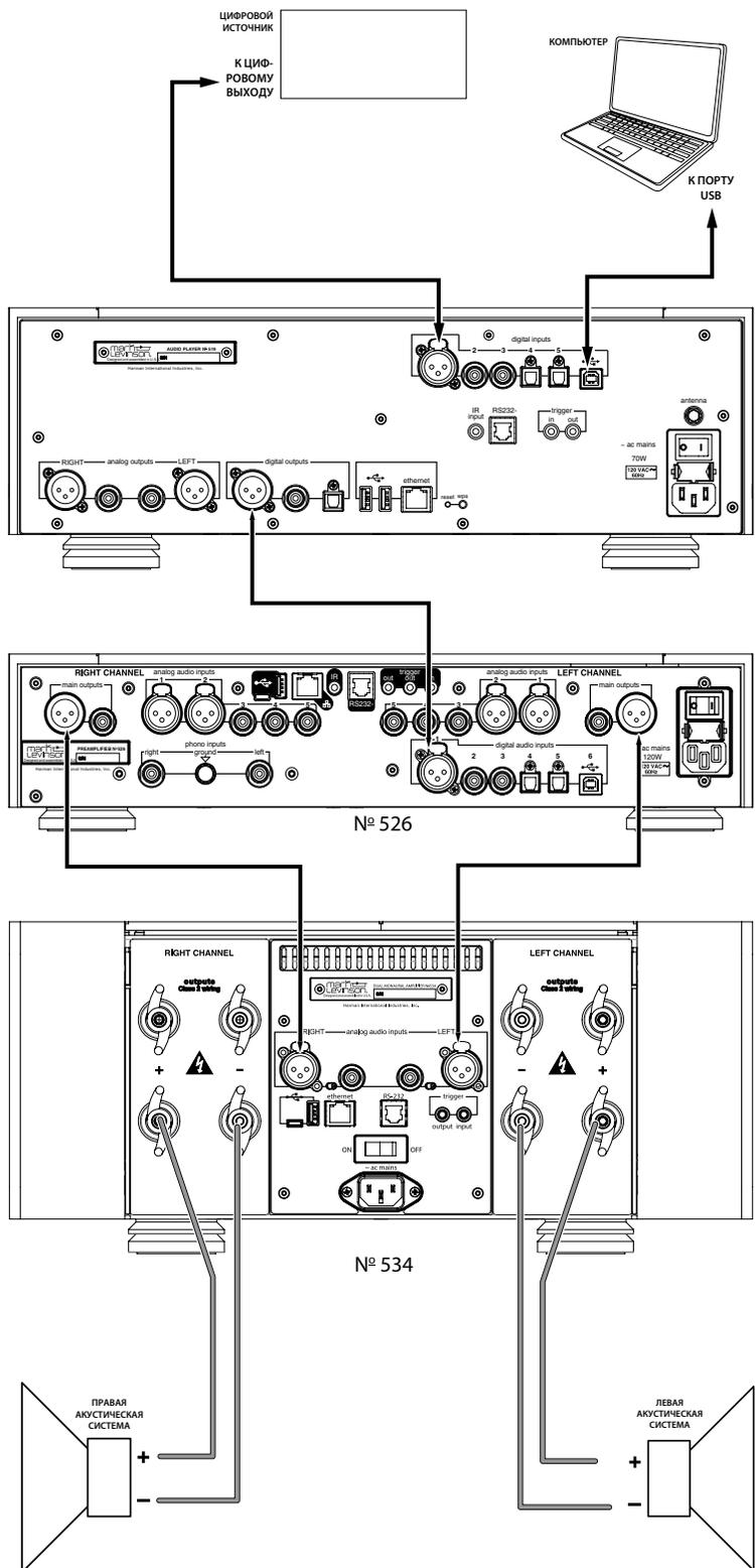
№ 519 подключен непосредственно с усилителю мощности
