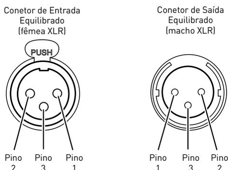
*Conectores de saída digital:* o N.º 519 tem três conectores de saída digital: XLR AES/EBU Equilibrada, RCA S/PDIF Coaxial e S/PDIF TOSLINK Ótica. Cada saída digital proporciona uma ligação digital de dois canais ao seu DAC ou pré-amplificador com DAC integrado. A Mark Levinson recomenda a utilização da saída digital Equilibrada para a melhor qualidade de som possível se a ligação estiver disponível no DAC ou pré-amplificador ao qual o leitor está ligado.
