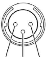
Pin 1 Pin 3 Pin 2 Gebalanceerde uitgang (mannelijke XLR)
